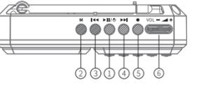
**1.电源开关:** 长按"▶▶▶"键3秒开机语音提示后,显示屏幕常亮表示正常开机,再次长按3秒显示屏幕熄灭表示已关机。
