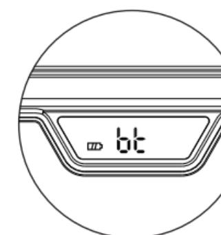
**第二步:**打开手机，进入手机的“设置”菜单，找到蓝牙功能选项，打开手机的蓝牙功能，点“扫描”按钮，待搜索到“M1000”点击“M1000”连接即可；同时，主机会提示配对成功；
